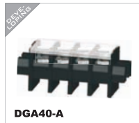
DGA40-A IEC 750V/40A 10mm 2 UL 300V/40A 20-8AWG Poles 1P-XXP
