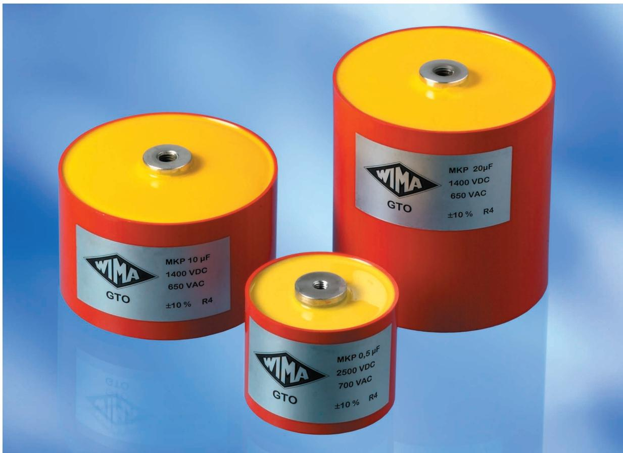
WIMA GTO MKP Kondensatoren sind speziell zur Be-dämpfung von Spannungsspitzen an GTO-Thyristoren und IGBT entwickelte Bauelemente. Sie werden im Trockenverfahren mit einer metallisierten Polypropylenfolie gewickelt und mit selbstverlöschendem Polyurethan-Harz in einem zylindrischen Kunststoffbecher vergossen. Aufgrund ihrer Bauweise zeichnen sie sich aus durch:
