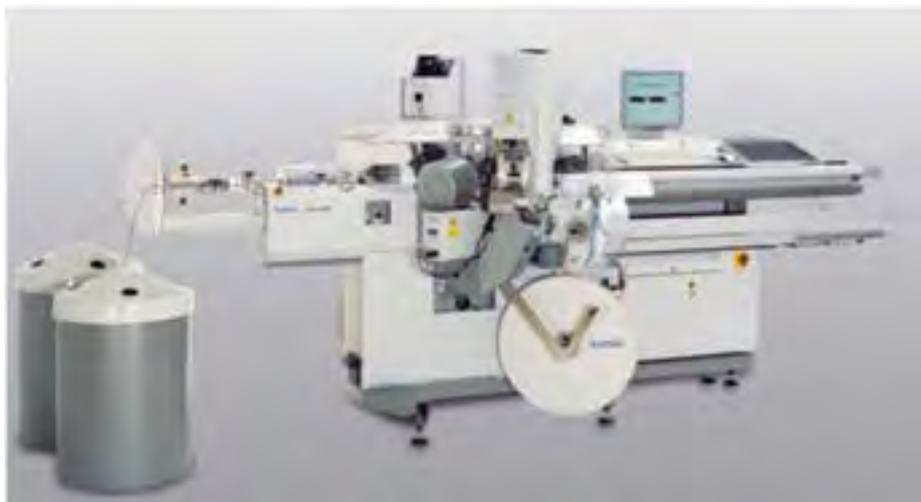
Die gegurteten Aderendhülsen mit den Artikelnummern V3MA... sind auch für alle Crimpmaschinen der Firma Komax geeignet.
