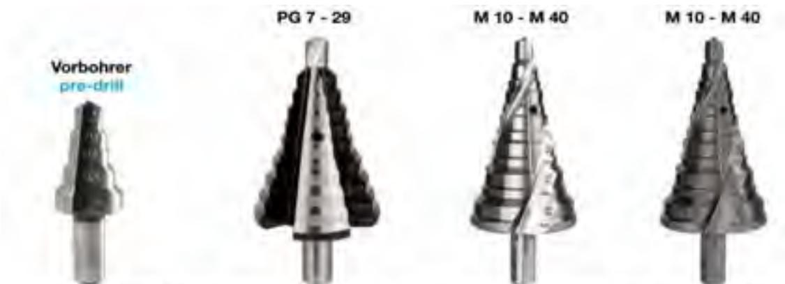
Speziell für Keilverschraubungen. Abgestimmt auf Bohrungen für Parzernschgewinde- Durchgangsloch (PG) oder metrische Gewinde Kern- und Durchgangsloch.
