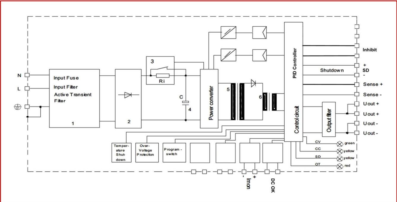
1) Active Transient Filter 2) Rectifier 3) Inrush Current Limiter 4) Load Capacitor 5) Power Transformer 6) Storage Choke
